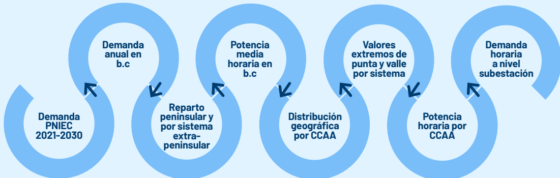
Figura 9. Proceso de obtención de la demanda horaria a nivel de subestación
